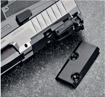
■ Stavitelné hledí LPA je vloženo do drážky na výměnné destičce, uchycené šrouby do závěru, vzadu za ním je další drážka přímo v materiálu závěru
