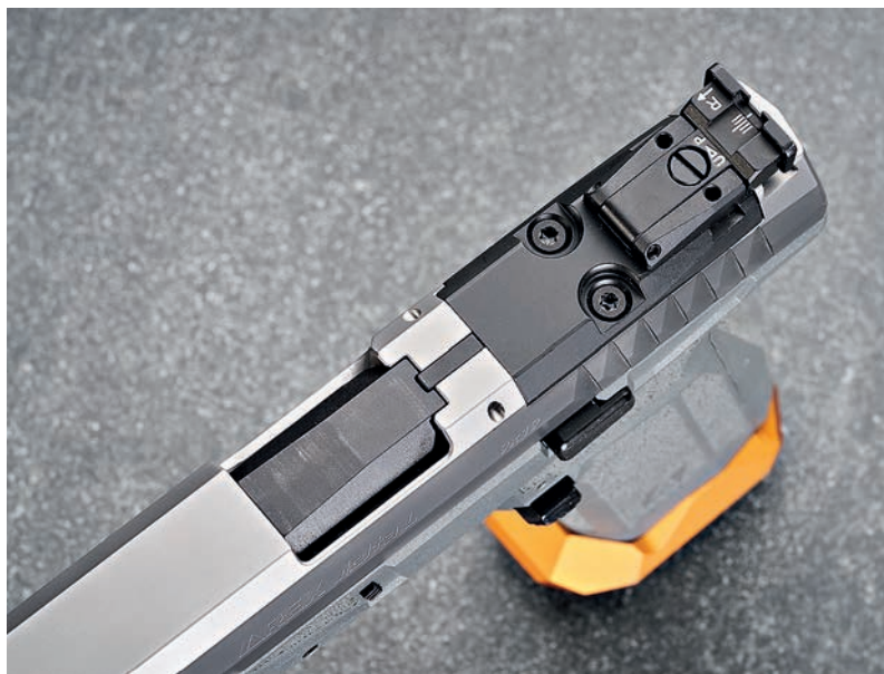
■ Na temeni závěru je mezi výhozným okénkem a výměnnou destičkou s hledím vložen výklopný indikátor přítomnosti náboje v komoře hlavně
